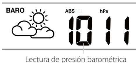
En modo normal, presione la tecla [ BARO ] para cambiar entre presión barométrica ABSOLUTA / RELATIVA.
